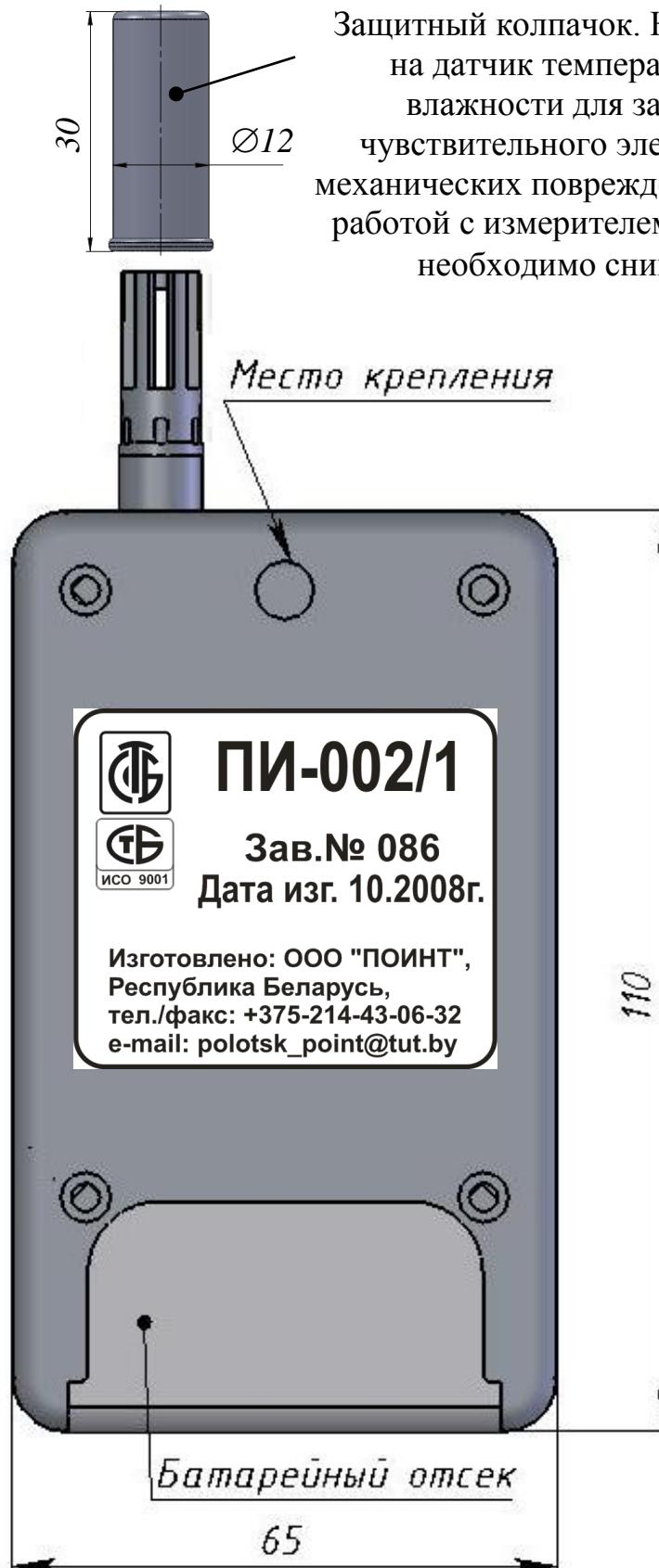
Защитный колпачок. Надевается на датчик температуры и влажности для защиты чувствительного элемента от механических повреждений. Перед работой с измерителем колпачок необходимо снимать.
