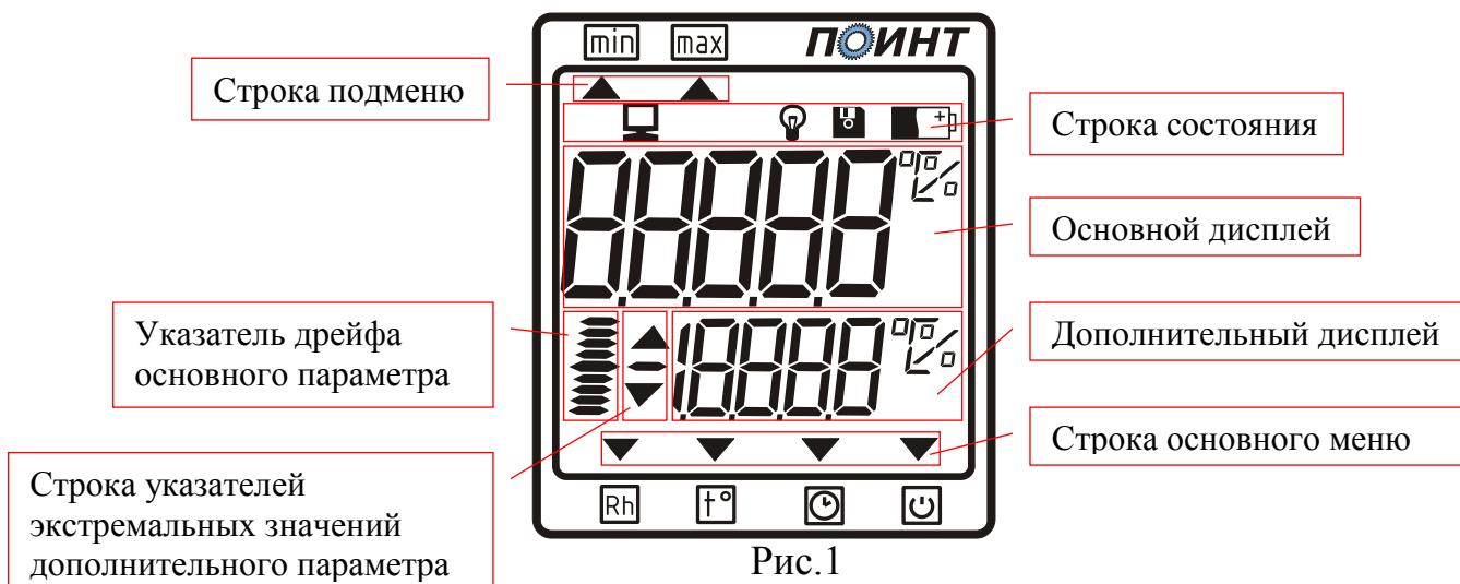
4.1. Для удобства отображения информации цифровой индикатор разбит на строку подменю, строку состояния, основной дисплей, дополнительный дисплей, строку основного меню, строку указателей экстремальных значений дополнительного параметра, указатель «дрейфа» основного параметра. Значение измеренной температуры или влажности отображаемое на дисплее округляется до одного знака после запятой.
